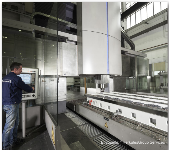
Portalfräsmaschine mit mehr als 10 m Durchgangsbreite, die ProfiMill-Serie von WaldrichSieggen
