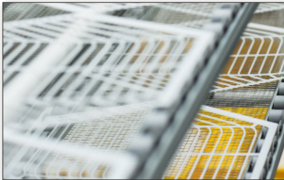
Stützlamellen für die Fertigung von feuchteübertragenden Wärmetauschern Bildquelle: PAUL Wärmerückgewinnung
