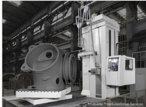
Bildquelle: © HerkulesGroup Services Bearbeitung einer riesigen Rotornabe eines Windrades mit einem UnionChemnitz Bohrerwerk
