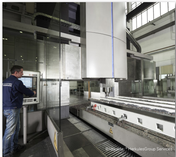
Portalfräsmaschine mit mehr als 10 m Durchgangsbreite, die ProfiMill-Serie von WaldrichSiegen
